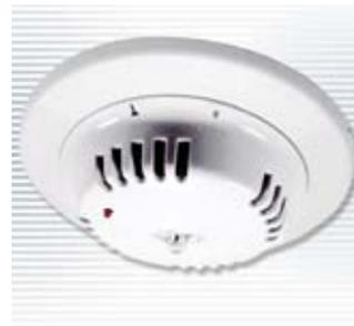
El **DS230**, **DS230F** y el **DS233F** están diseñados para operar con la serie de bases de montaje MB para proveer una correcta protección. Cuando están correctamente instalados utilizando alguna base de la serie MB2W (2 hilos) / MB4W la protección antidesarme hace que la central de alarmas reciba una señal de falla toda vez que se quite algún detector de su base.
