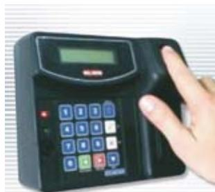
Este control biométrico elimina definitivamente los fraudes y problemas de seguridad ocasionados por el intercambio de tarjetas y claves entre el personal. También es posible incluir dentro del gabinete un lector de tarjetas de proximidad y utilizarlo de manera conjunta con la huella dactilar, logrando así la máxima seguridad y velocidad en el re-
