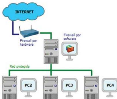
Como puede observarse, un Firewall, sólo sirve de defensa perimetral de las redes, no defiende ataques o errores provenientes del interior, como tampoco puede ofrecer protección una vez que el intruso lo traspasa.
