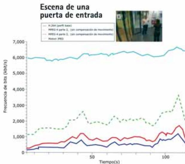
Un codificador H.264 creó hasta un 50% menos bits por segundo para una secuencia de video de muestra que un codificador MPEG-4 con compensación de movimiento. El codificador H.264 fue al menos tres veces más eficiente que un codificador MPEG-4 sin compensación de movimiento y al menos seis veces más eficiente que Motion JPEG.
