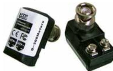
Para longitudes mayores se utilizan balunes activos que incluyen amplificadores diferenciales con una buena relación de rechazo de modo común (CMRR). El amplificador lee la señal diferencial entre los cables y elimina la mayor parte del ruido no deseado. Cuanto más perfecto sea el balance del sistema menor será la interferencia externa.
