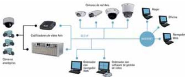
Un sistema de video en red está compuesto por elementos como cámaras de red, codificadores de video y software de gestión. El resto de los componentes, incluidos la red, el almacenamiento y los servidores, forman parte del equipo de TI estándar.
