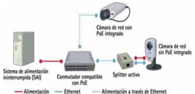
Un sistema que utiliza la Alimentación a través de Ethernet
