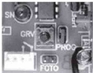
Presionar y liberar simultáneamente los dos botones de control remoto (grabado) dos veces, pausadamente; el LED parpadea. Espere 5 segundos para que la central entre en modo de programación automática (luego continuar desde el Punto 6, Paso 4).
