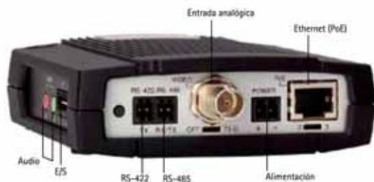
Codificador de video independiente de un canal con audio, conectores E/S (entrada/salida) para controlar dispositivos externos como sensores o alarmas, puertos de serie (RS-422 / 485) para el control cámaras analógicas PTZ y conexión Ethernet con soporte de alimentación a través de Ethernet (PoE).
