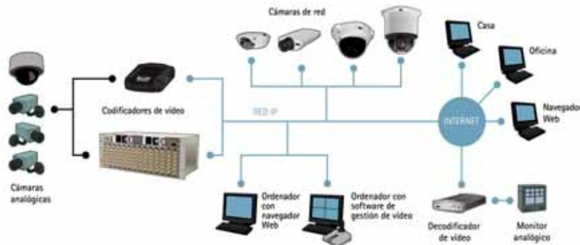
En la ilustración se muestra como pueden integrarse cámaras de video analógicas y monitores analógicos en un sistema de video en red utilizando codificadores y decodificadores.
