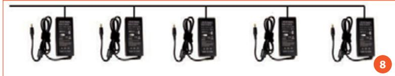
de una única fuente, además de poder implementar un sistema de alimentación ininterrumpida de manera inmediata, agregando desde un cargador de batería hasta una UPS online. La desventaja es que, para distancias largas que van desde la fuente hasta la cámara, debemos considerar la sección del cable para no perder demasiada potencia (imagen 7).
