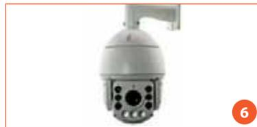
cobertura angular vertical (TILT o cabeceo). Su rango máximo de paneo es 350° y de cabeceo 60°. Se controla por joystick. Puede trabajar en combinación con el control motorizado de lentes ZOOM, que permite el control manual de las funciones de la lente. Su aplicación hoy está limitada a necesidades de amplia robustez, propiedades antivandálicas o requisitos de distancias focales fuera de los alcances de las lentes estándar.
