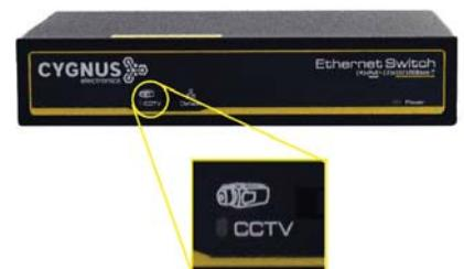
rando la eficiencia de la retransmisión de datos, mejorando del uso del ancho de banda y la seguridad integral del sistema. Además, se limita el ancho de banda de los puertos de bajada a 10 Mbps, lo que permite, en conjunto con la poderosa fuente PoE, alcanzar distancias de cableado por UTP hasta 250 m sin necesidad de utilizar extensores adicionales, siendo el único switch en el mercado con esta singular característica.
