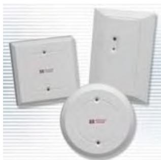
La Serie de Detectores de Rotura de Vidrios **DS1100i** utiliza Tecnología de Análisis del Sonido (**SAT**) la que permitirá la generación de una alarma solo en caso de que la señal detectada tenga una relación específica entre frecuencia, polaridad y período. La sofisticación de esta técnica de procesamiento asegura un comportamiento fiable libre de falsas alarmas.
