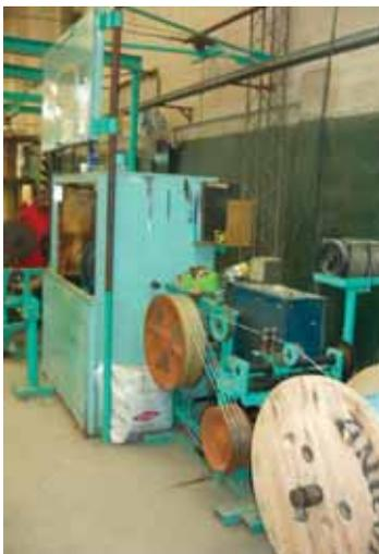
Cableadora de hasta 100 pares de multipares telefónicos.
