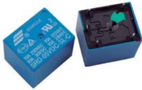
El relé es un interruptor o switch automatizado. Para explicarlo de manera sencilla, es como la llave de un velador, la cual es accionada con una corriente de entrada. Básicamente, al enviarle corriente, cambia de estado normal cerrado a normal abierto, permitiendo o negando así el paso de una corriente o un pulso eléctrico. Una de las características principales del relé es que permite controlar un artefacto que requiera mayor corriente que la que se le entrega para accionarse.
